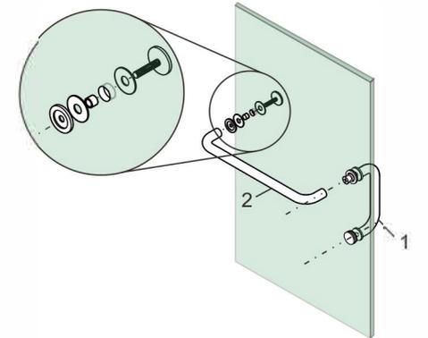
Installez les vis de réglage et serrez avec la clé Allen pour terminer l'installation.
